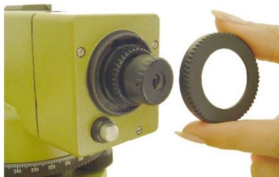
شکل ۵: باز کردن درپوش و تنظیم تار رتیکول
