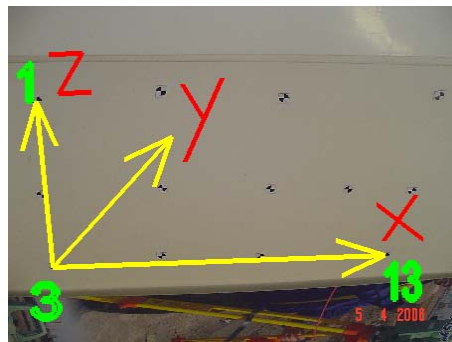
شکل (۴) : سیستم مختصات محلی مورد استفاده جهت توجیه مطلق تصاویر
