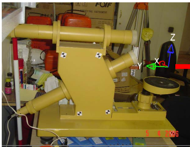
شکل (۶) : نحوه تصویر برداری از کلیماتور دور محوره
