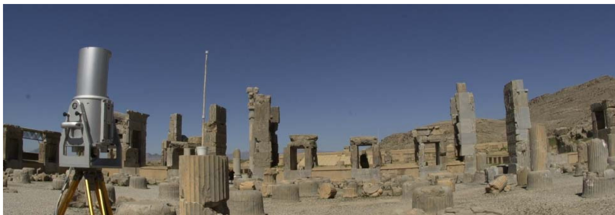
کاخ صد ستون، تخت جمشید، دستگاه اسکنر لیزری ۳ بعدی LMS-Z360 ساخت ریگل اتریش
